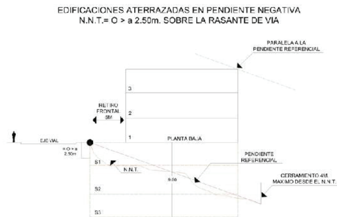
Figura 22. Edificaciones Aterrazadas en Pendiente Negativa con N.N.T. = > -2.50 m.
